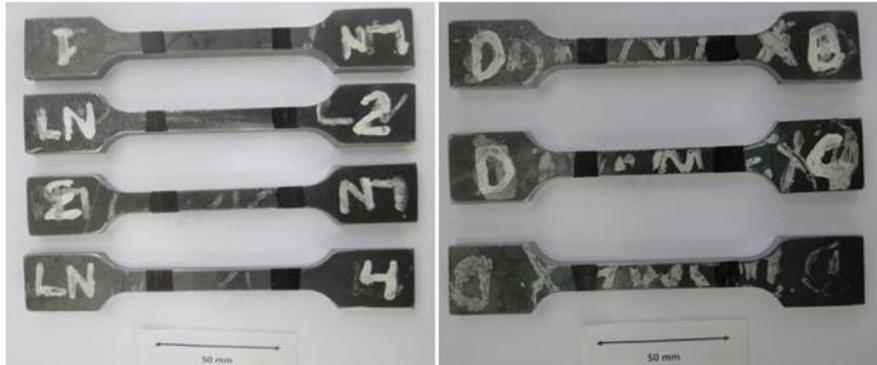
Figura 3.5 Corpos de prova para ensaio de tração dos metais base.
