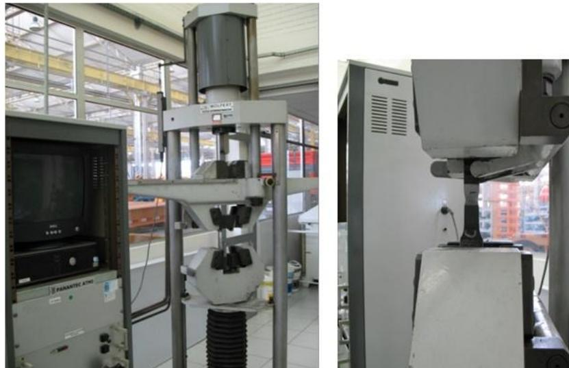
Figura 3.11 Máquina de ensaio de tração/compressão Wolpert.
