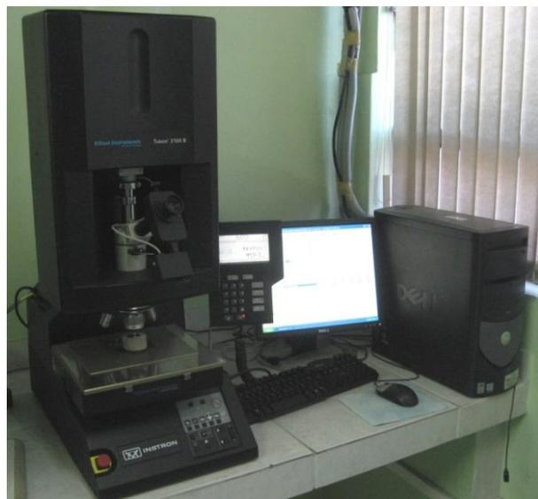
Figura 3.9 Equipamento Instron modelo Tukon 2100 B utilizado para medição do perfil de microdureza.
