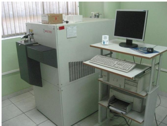
Figura 3.12 Espectrômetro de emissão ótica Spectro Lab.
