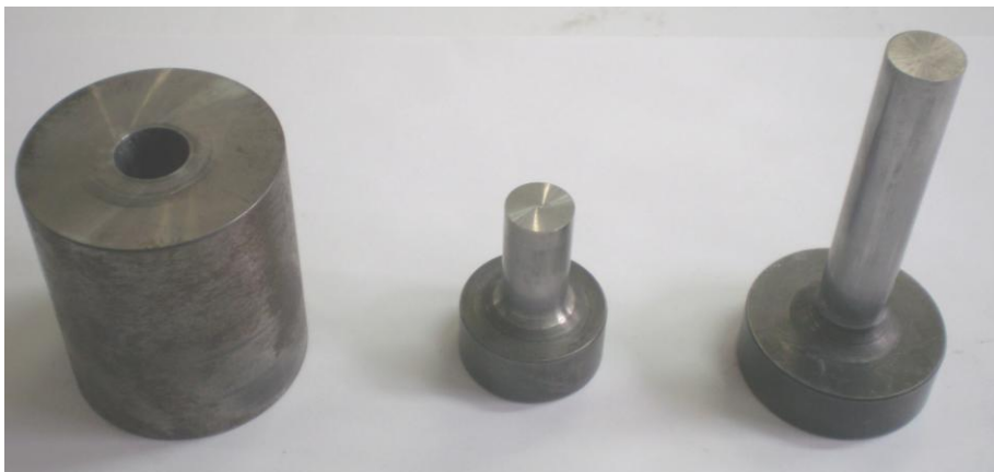
Figura 14 – Matriz para compactação dos corpos de prova na forma de cilindro
