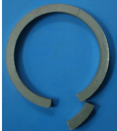
Figura 39 – Amostra para análise metalográfica retirada do anel
