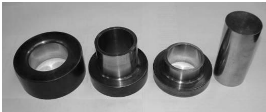
Figura 16 – Matriz para compactação dos corpos de prova na forma de anel
