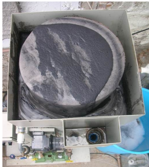
Figura 15. Processo FFC-A. Vista superior do topo da coluna de flotação.
