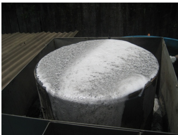
Figura 22. Processo FFC-A. Topo da coluna de flotação com o material flotado (lodo).
