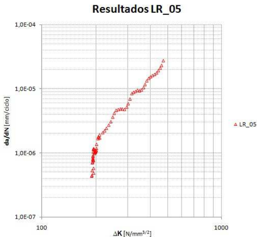
Figura 4.6 - Curva de propagação de trinca obtida para o corpo de prova LR_05.
