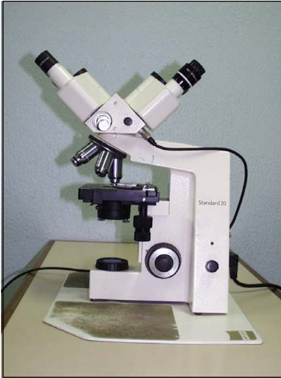
Fig.4: Microscópio óptico de dupla observação, da marca Zeiss modelo Standard 20 com quatro objetivas (2,5, 20, 40 e 100 aumentos) e ocular com aumento de dez vezes. Diâmetro do campo de microscopia com objetiva de 400 = 0,4 mm.
