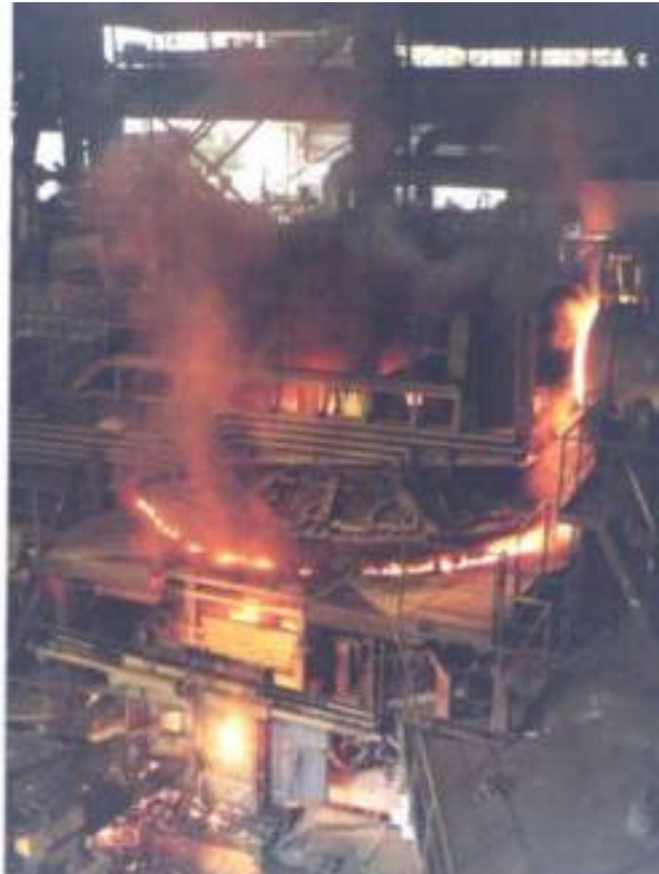
Figura 52 - Forno elétrico em operação de fusão.
