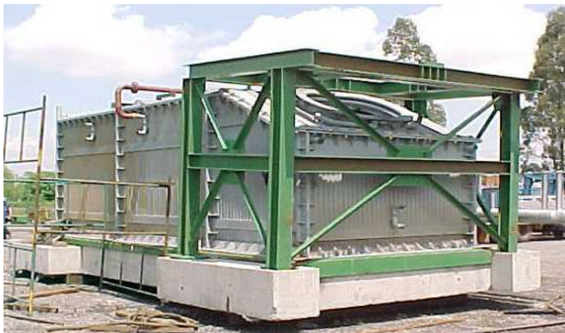
Figura 36 - Câmara de combustão pré-montada.
