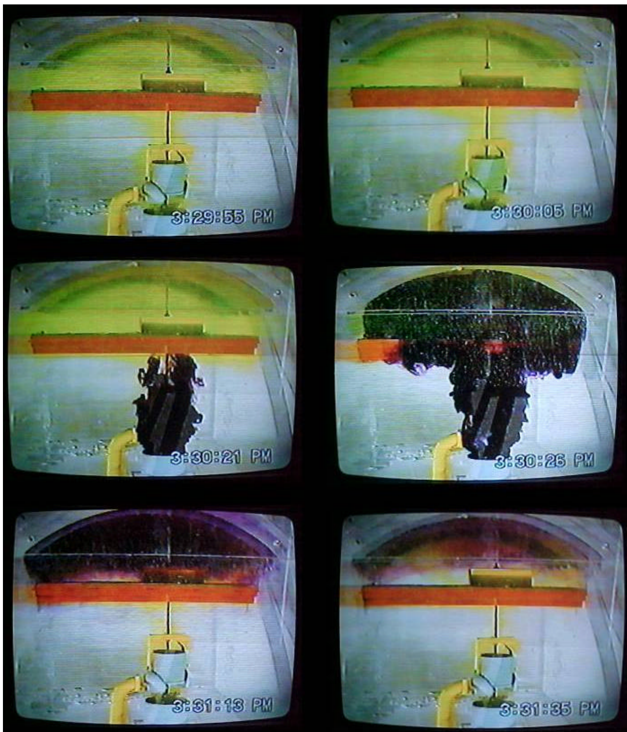
Figura 26 - Modelamento hidráulico, opção 1, vista de oeste, volume da coifa 953 \text{ m}^3 , vazão de exaustão 222.800 \text{ m}^3/\text{h} , resultado da eficiência de 89,7% de captura de particulados, com único ponto de exaustão na coifa.
