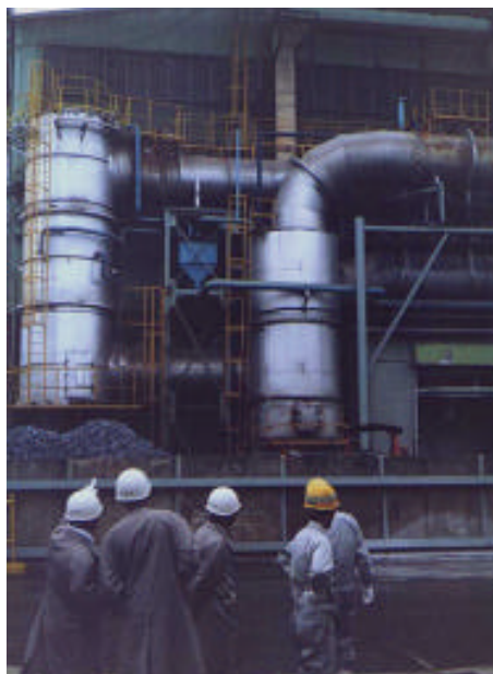
Figura 13 - Câmaras de combustão recebendo os gases primários.
