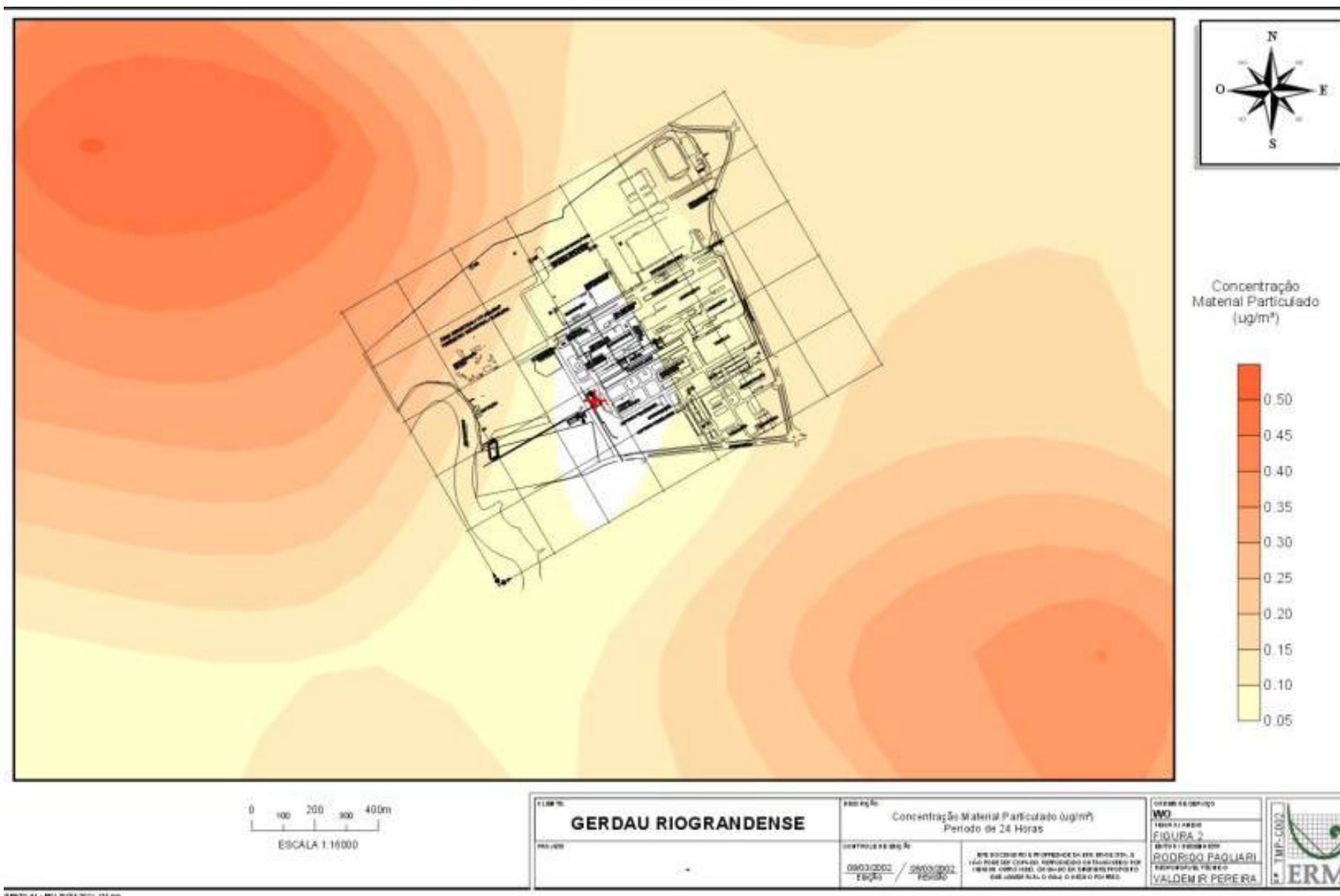
Figura 59 - Isopleta com resultados do estudo de dispersão após a implantação do novo sistema de despeiramento.
