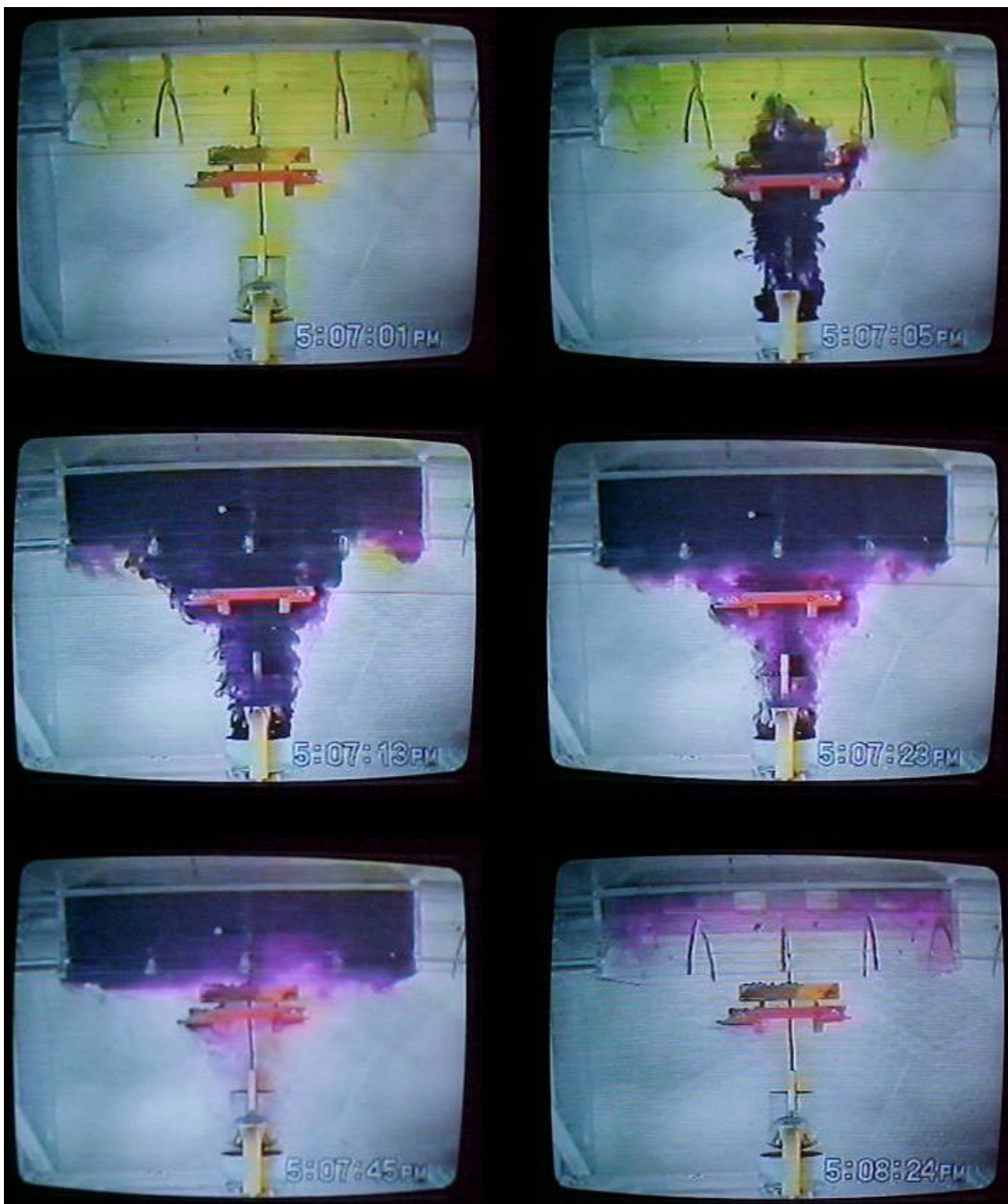
Figura 27 - Modelamento hidráulico, opção 3, vista de norte, volume da coifa 1.975 \text{ m}^3 , vazão de exaustão 301.500 \text{ m}^3/\text{h} , resultado da eficiência de 100% de captura de particulados, com quatro pontos de exaustão na coifa.
