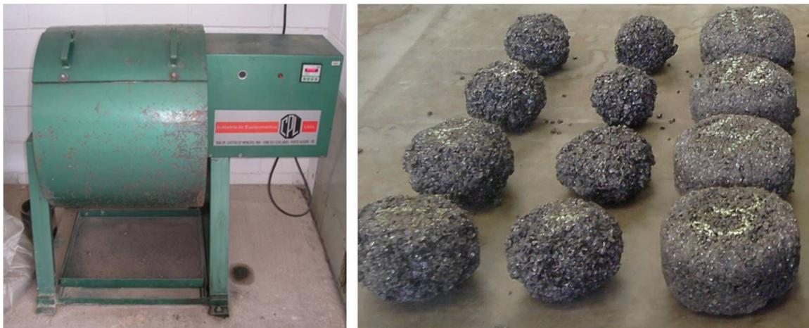
Figura 20: Máquina de abrasão Los Angeles e amostras após ensaio
