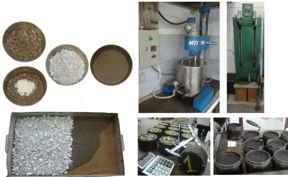
Figura 15: Preparação dos agregados e moldagem das amostras
