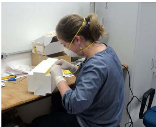
Figura 96: colagem nos papéis sensíveis à água nas fachadas dos modelos em sala climatizada
