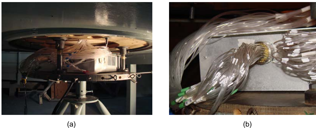
Figura 88: (a) e (b) mangueiras ligadas aos transdutores de pressão do túnel de vento
