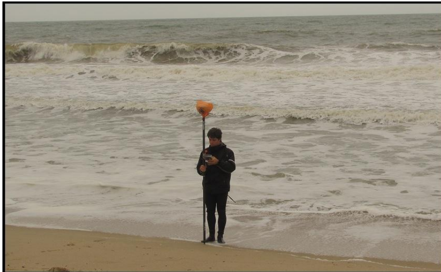
Figura 40 Método de medição do wave run-up . Para cada espraiamento de onda foi coletado um dado. Foto: Diego Bitencourt.
