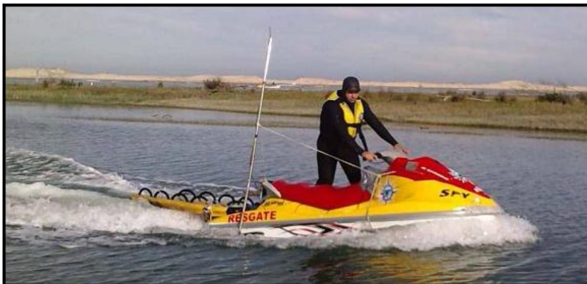
Figura 19 Moto aquática ( jet ski ) utilizada nos levantamentos batimétricos de detalhe ao largo da praia de Morro dos Conventos. É possível observar a haste de suporte do transdutor e a antena de transmissão de dados. (fonte: CPE, 2009).
