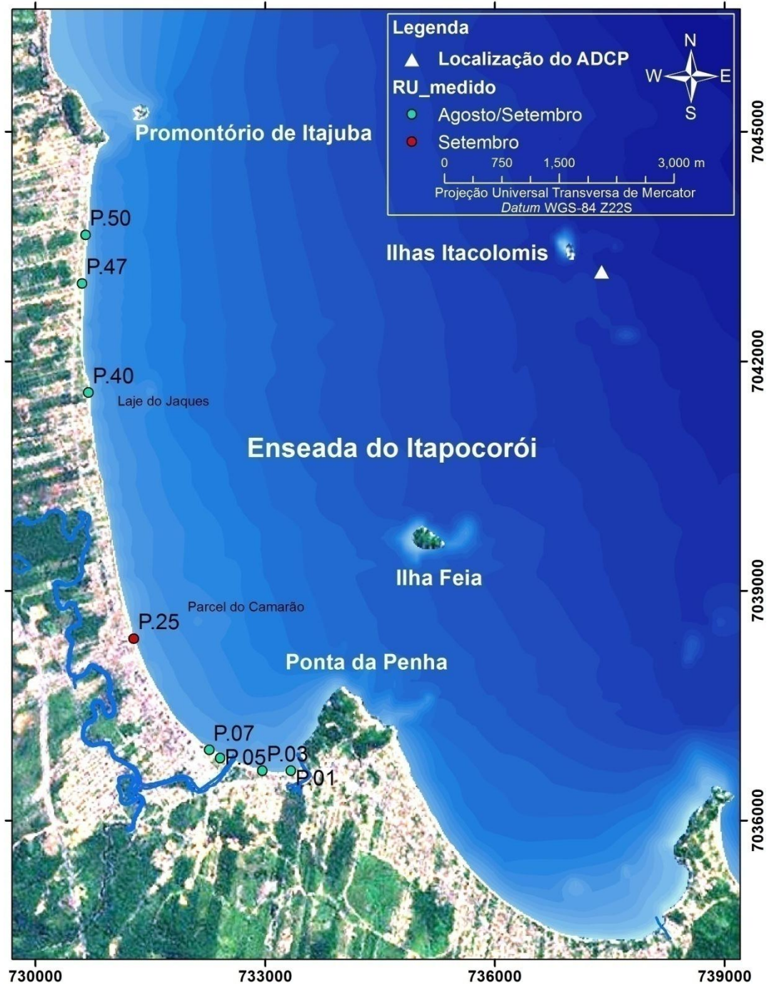
Figura 38 Localização do fundeio do equipamento ADCP e os pontos onde foram medidos wave run-up . Em verde os pontos medidos desde agosto e, em vermelho aquele adicionado em setembro.
