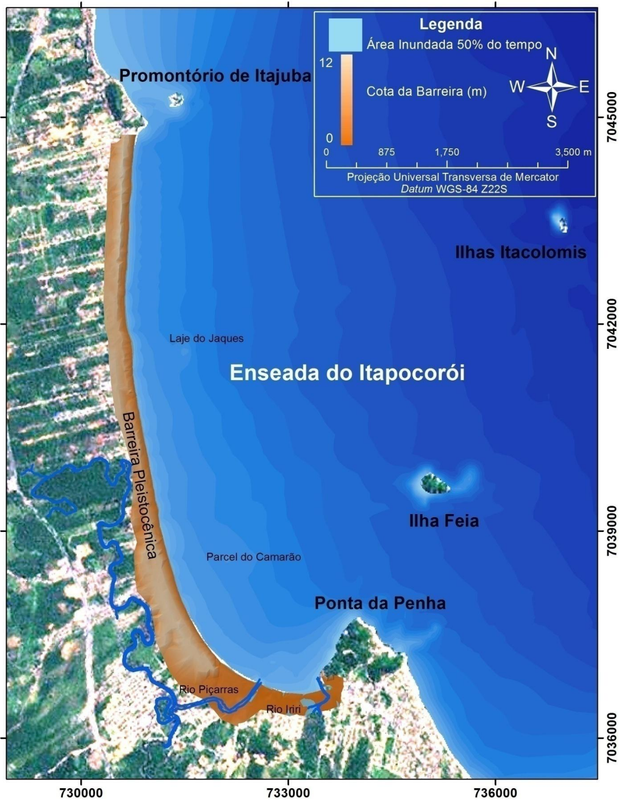
Figura 54 Área inundada 50% do tempo. Nota-se que, praticamente, apenas a face da praia é atingida, sendo que toda região do pós-praia não é afetada em condições normais.
