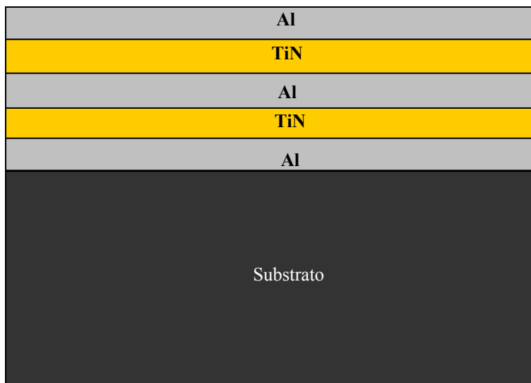
Figura 3.5 Esquema do filme fino para o sistema TiN/Al. Todos os conjuntos de amostra tiveram este padrão, duas camadas do material a ser analisado intercaladas por três camadas de alumínio.
