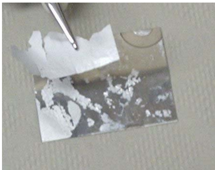
Figura 3.7 Fotografia mostrando a retirada do filme fino de TiN/Al.
