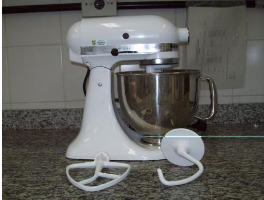
Figura 09 - Fotografia da Batedeira, com “bowl”, batedor raquete e batedor tipo gancho.
