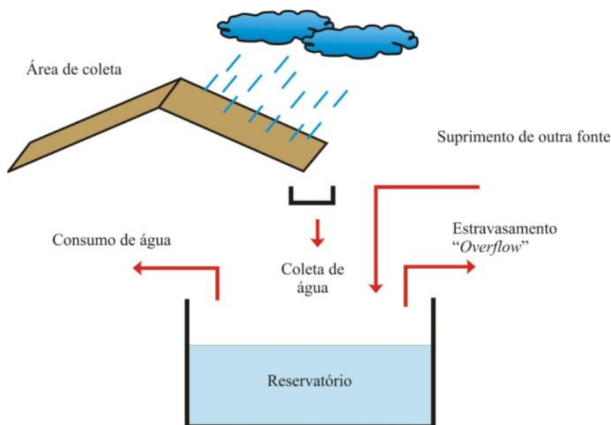
Figura 8 – Esquemática de um sistema de aproveitamento de água de chuva e seus fluxos de água (Cheng (2000) apud May (2004))
