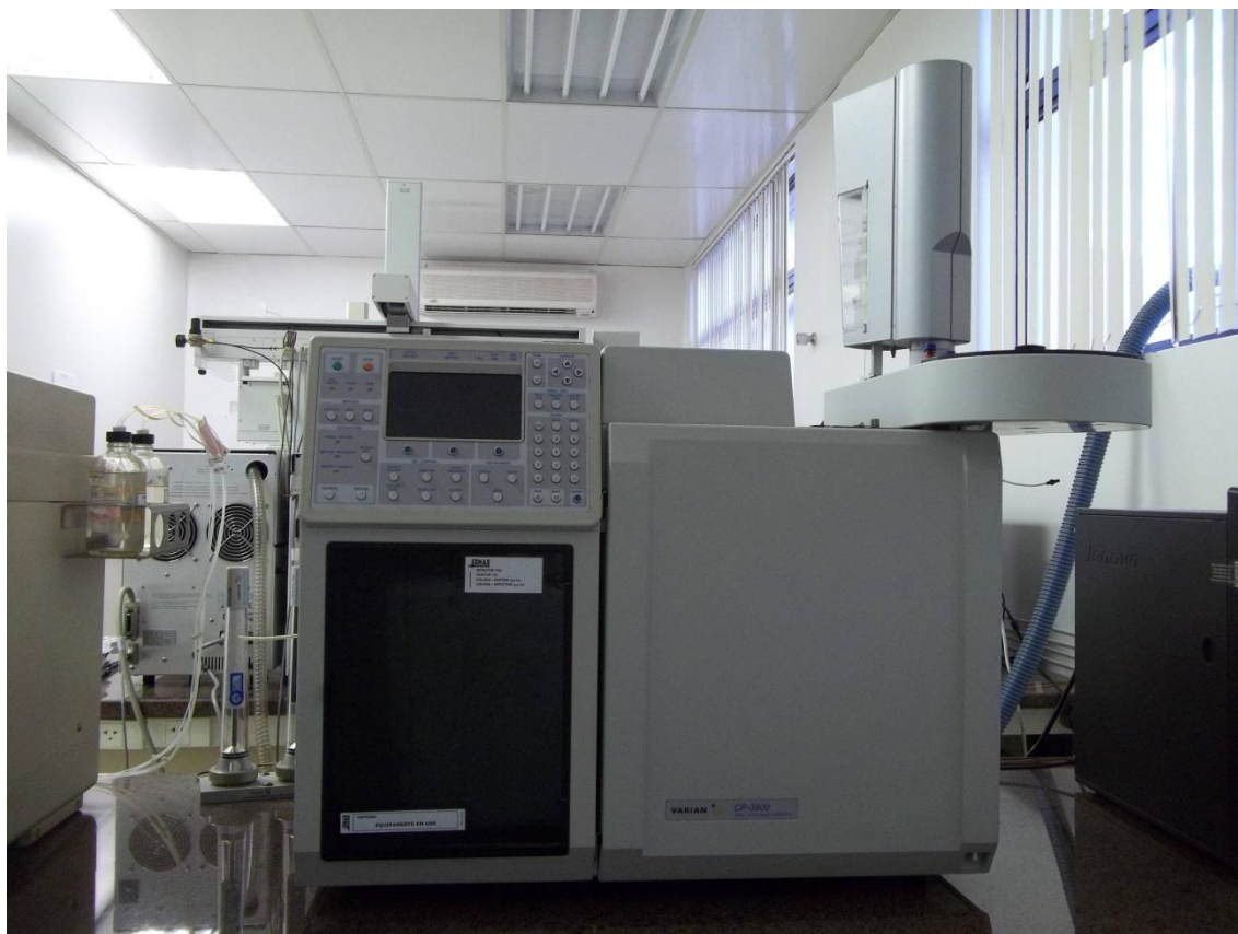
Figura 7: Cromatógrafo a gás da marca Varian, modelo 3800, equipamento da SCPA no setor de Cromatografia a Gás do DMAE
