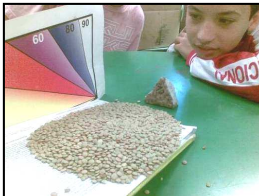
Figura 27 – Experiência para o entendimento do grau de escorregamentos dos materiais.
