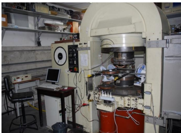
Figura 29 – A Prensa Hidráulica com Câmara Toroidal de 1.000 tonf com sistema de refrigeração, pertencente ao Laboratório de Altas Pressões e Materiais Avançados do Instituto de Física.
