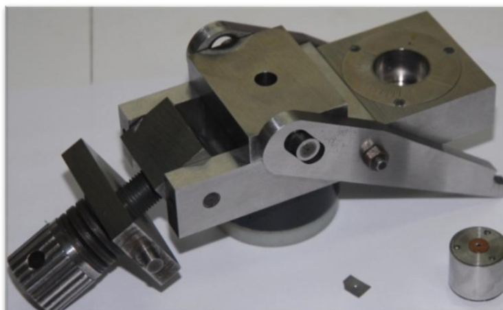
Figura 21 – Foto da DAC desmontada, o cilindro é a bigorna superior e a chapinha de metal o porta amostra.
