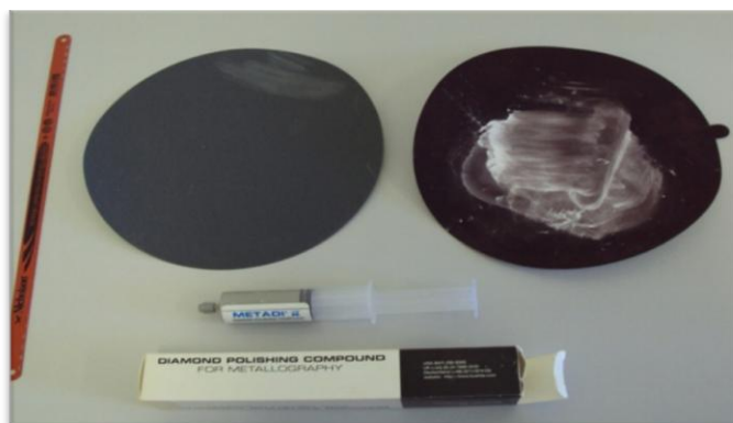
Figura 39 – Lixas usadas no polimento das pastilhas. Na seringa há a pasta de diamante a \frac{1}{4} de \mu\text{m} .
