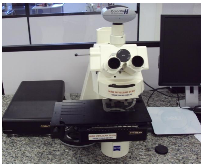
Figura 42 - Autoscan de 3 eixos montado em um microscópio Zeiss, do Laboratório de Geologia Isotópica da UFRGS.
