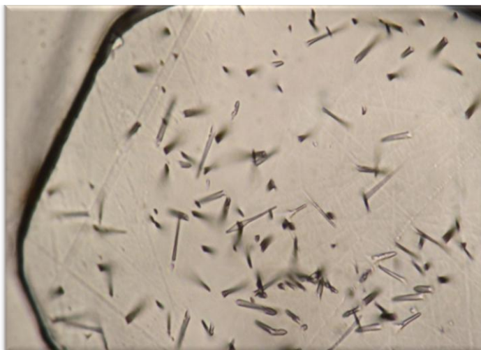
Figura 36 – Imagem de microscopia óptica com aumento de 400 vezes de um grão de apatita de Durango mostrando traços de fissão gerados por irradiação. Os traços confinados da amostra têm \approx 16 \mu\text{m} .
