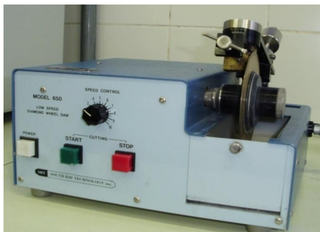
Figura 13 - Serra de diamante modelo 650 (South Bay Technology inc.) do Centro de Microscopia Eletrônica – Instituto de Física.
