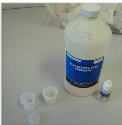
Figura 38 – Resina Castolite usada na manufatura das pastilhas para microscopia óptica.
