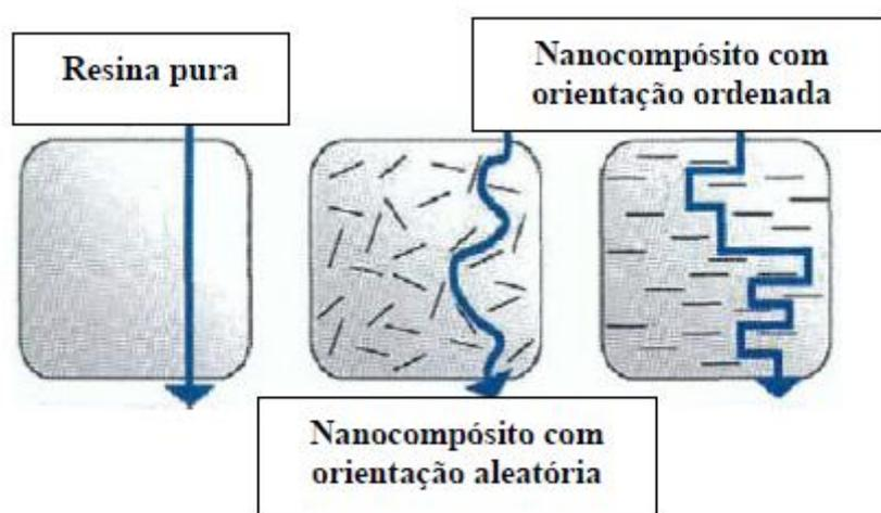
Figura 16. Representação esquemática da difusão de gases na matriz polimérica.
