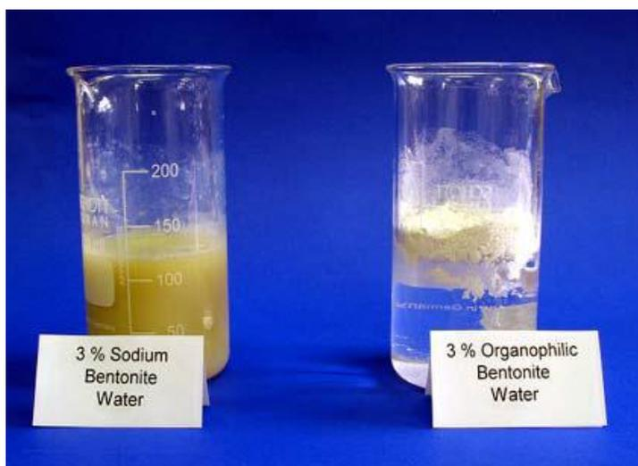
**Figura 23. Diferença de comportamento entre argila modificada e não modificada, em água<sup>[53]</sup>.**
