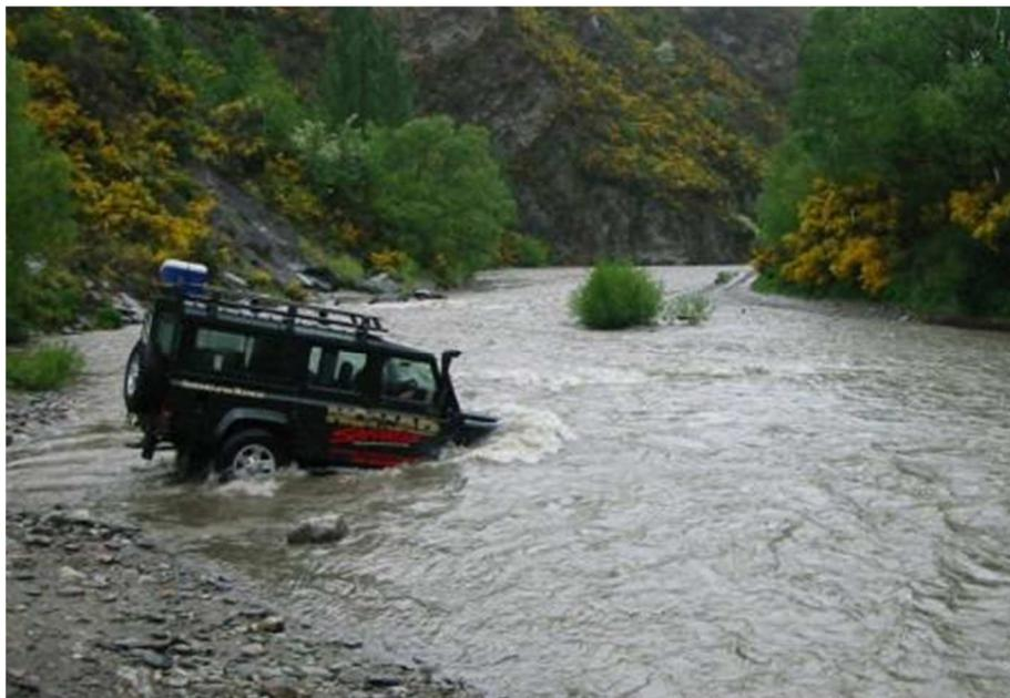
**Figura 10.** Travessia de curso d'água em andamento. Note o uso do *snorkel* (o tubo que corre pela lateral do pára-brisa)<sup>36</sup>.
