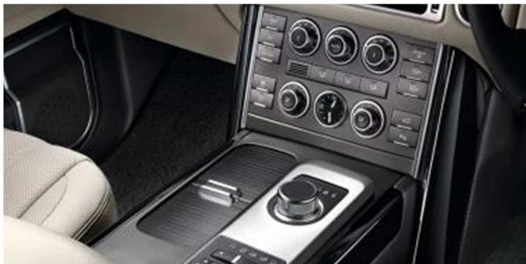
**Figura 22.** Detalhe do console central, com botão de controle da transmissão no painel horizontal (LAND ROVER, 2011).
