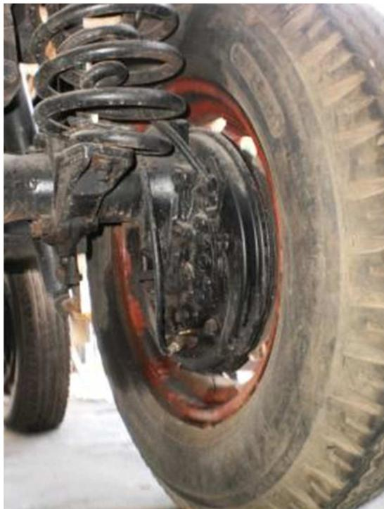
**Figura 83.** Detalhe do eixo pórtico (fonte: autor).
