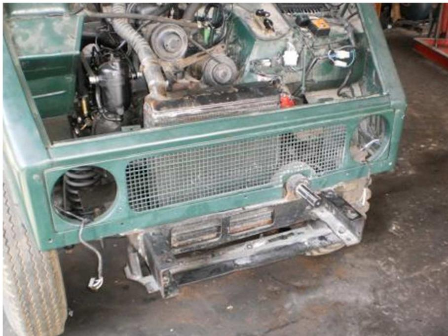
**Figura 86.** Porção frontal do Unimog, com tomada de força dianteira visível (fonte: autor).
