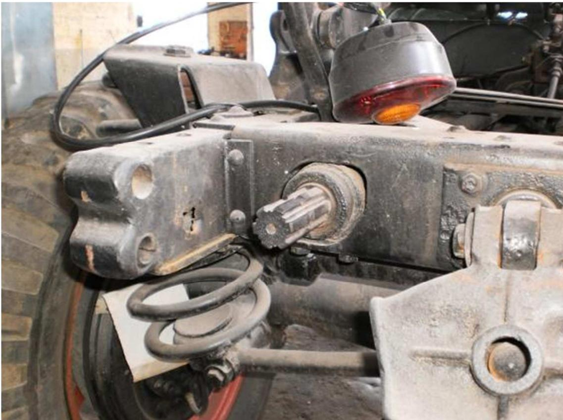
**Figura 85.** Tomada de força para implementos (eixo cilíndrico com caneladuras). Fonte: autor.
