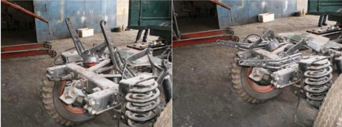
**Figura 84.** Suporte retrátil para implemento agrícola. A potência para o implemento é fornecida por tomada de força, outro item distintivo do Unimog (fonte: autor).
