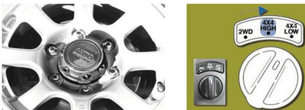
**Figura 12.** Esquerda: Acionamento manual da roda-livre por chaveta no cubo da roda. Direita: Acionamento automático da roda-livre e da caixa de transferência por botão no console central<sup>43</sup>.
