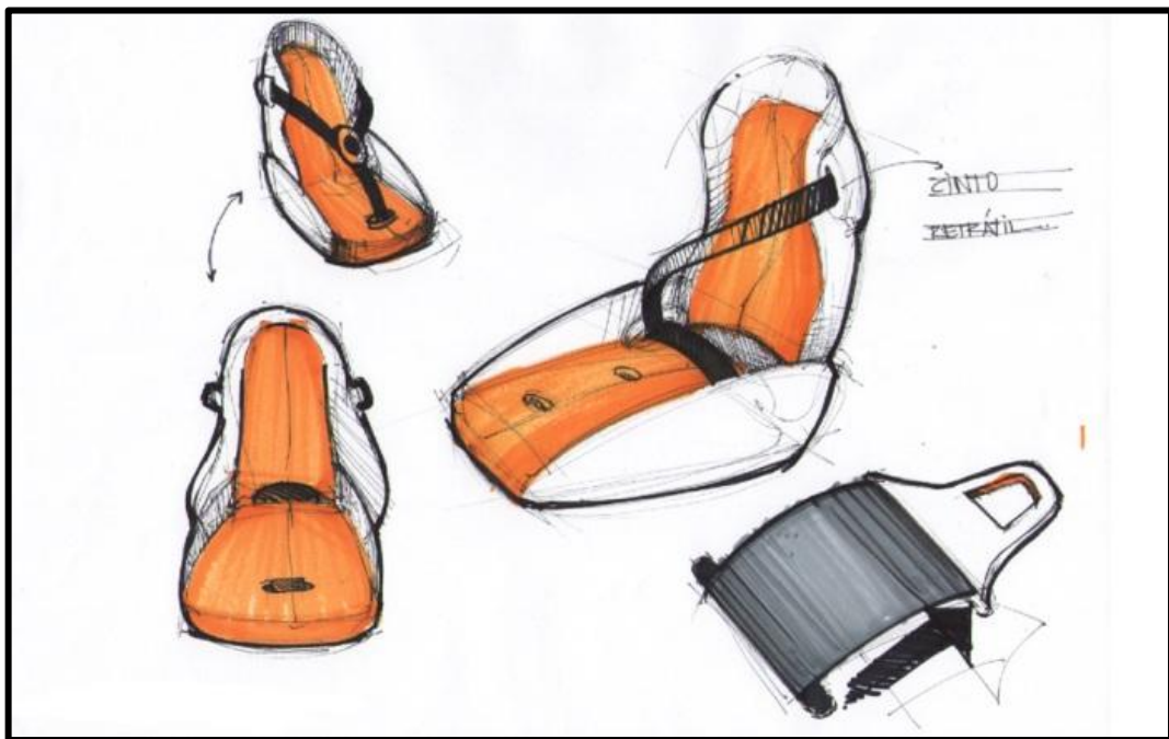
Figura 44: Sketches da alternativa com cinto de segurança retrátil
