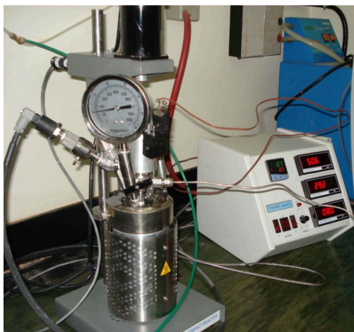
Figura 2. Reator Parr 4843 utilizado nas reações de oligomerização.
