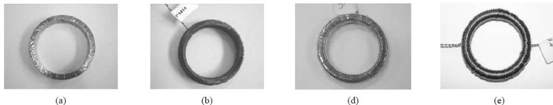
Figura 40 Etapas da preparação das amostras: (a) isolamento, (b) enrolamento secundário, (c) isolamento e (D) enrolamento primário [30].
