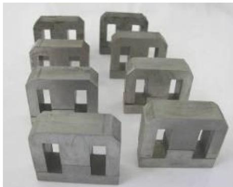
Figura 34– Amostras dos núcleos compactados obtidos através da metalurgia do pó.
