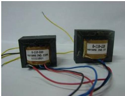
Figura 32- Transformadores 6V/500mA e 12V/600mA.
