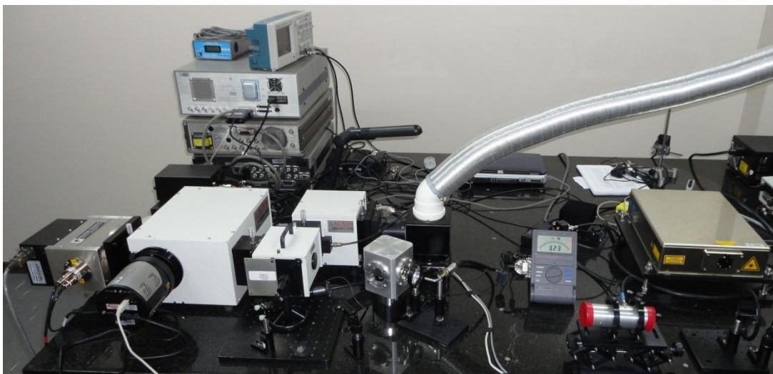
Figura 16: Imagem do equipamento utilizado para medidas de PL.
