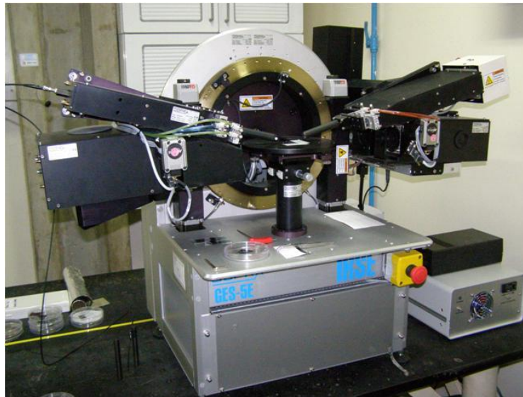
Figura 26: Elipsômetro de extinção SOPRA GES-E utilizado para caracterização.
