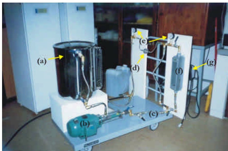
Figura 4.3 - Equipamento de filtração (seta indicando suporte onde é colocada a membrana).
