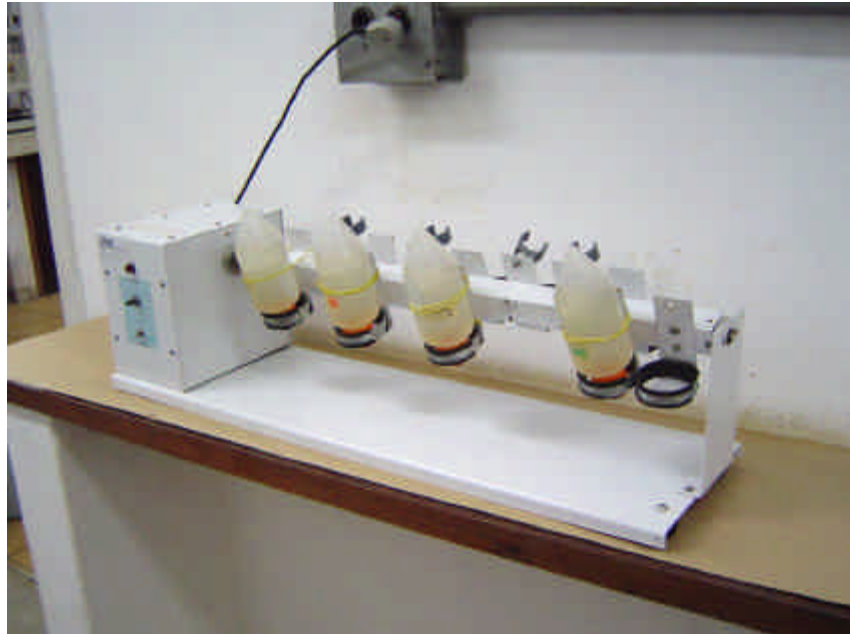
Figura 4.4 - Agitador e tubos cônicos de centrifuga contendo membranas para eluição (este equipamento foi fabricado por técnicos da UFSC).
