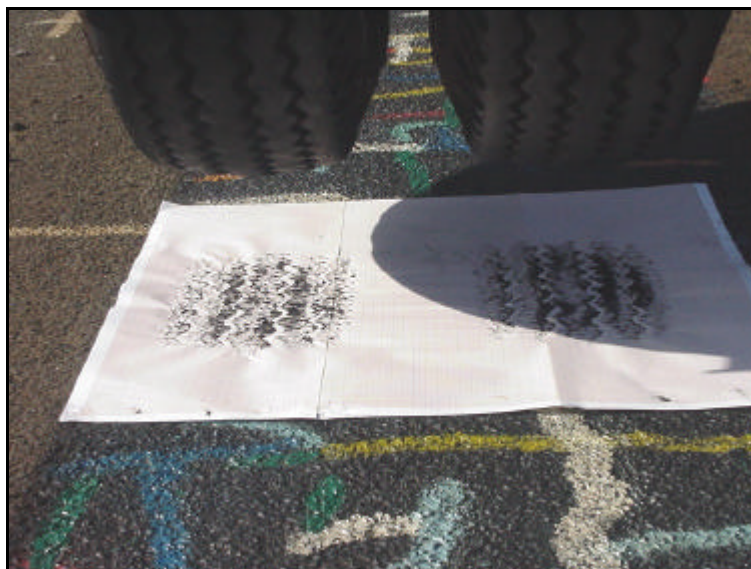
Figura 26: Impressão dos pneus com carga de eixo de 100kN
