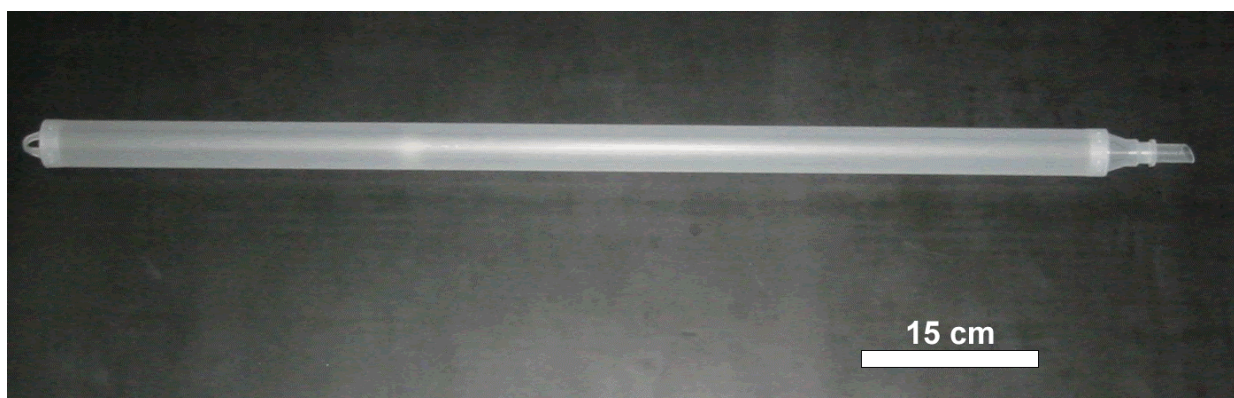
Figura 4 – Amostrador do tipo Bailer utilizado para a coleta de amostras de água subterrânea na área de estudo.
