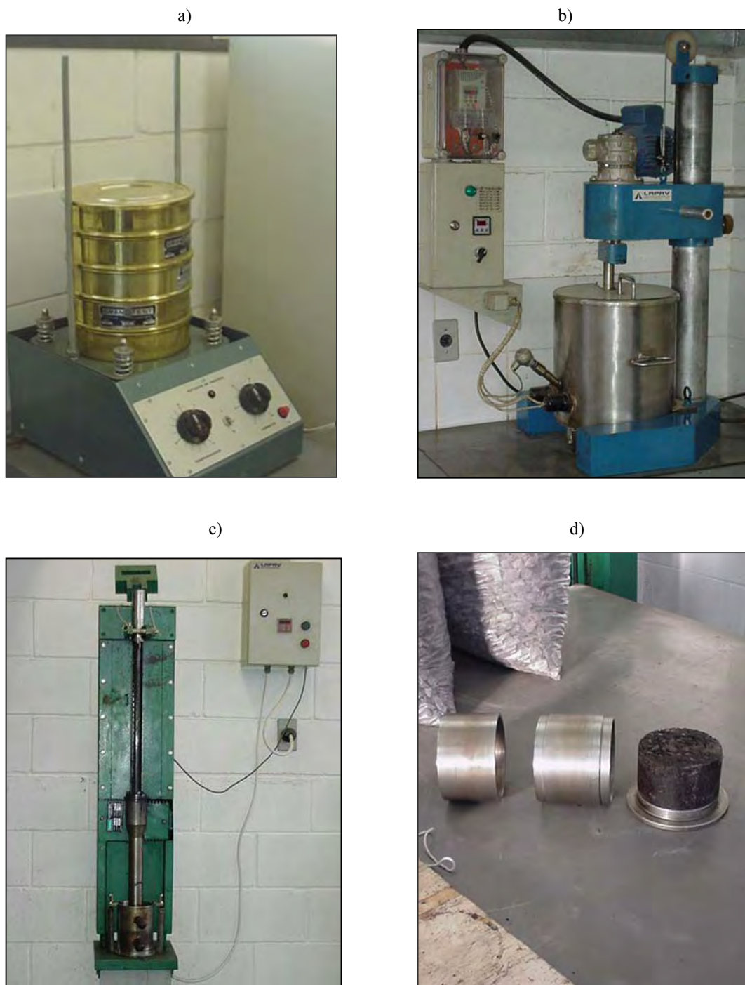
Figura 4.10 – Equipamentos utilizados nas etapas de preparação das amostras a) agitador de peneiras para agregados b) misturador elétrico com cuba aquecida c) compactador Marshall d) molde utilizado para preparação das amostras de CBUQ
