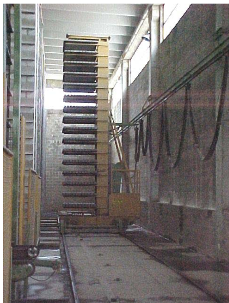
Figura 21: Transporte do produto de concreto no estado fresco para a câmara de cura Fonte: Obtido junto a empresa
