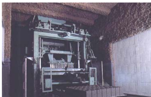
Figura 19: Moldagem dos produtos por vibro-compressão Fonte: Obtido junto a empresa
