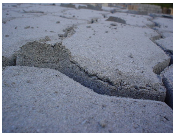
Figura 60: Desgaste na parte inferior do molde Fonte: Obtido junto a empresa
