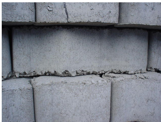
Figura 59: Forma irregular Fonte: Obtido junto a empresa
