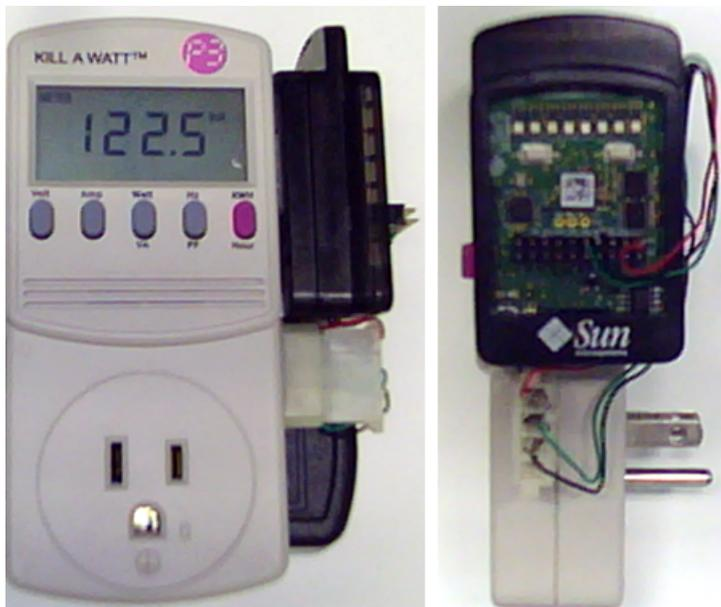
Figura 5.13: Sistema embarcado implementando a arquitetura proposta.
