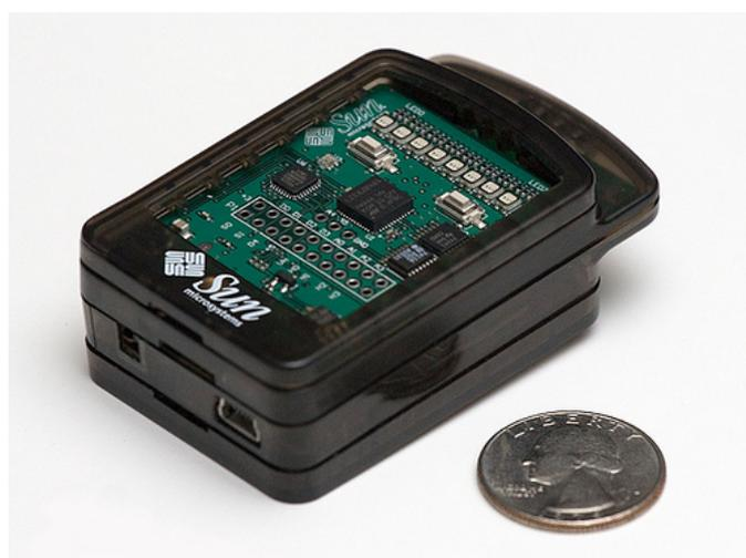
Figura 5.3: Plataforma para dispositivos embarcados SPOT.
