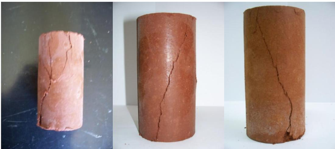
Figura 4.4 – Padrão característico de ruptura dos corpos-de-prova submetidos à compressão simples
