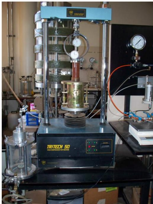
Figura 3.1 – Ensaio de Resistência à Compressão Simples
