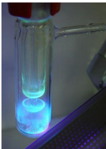
Figura 46. Sublimação do HBO para a purificação do complexo 33 .
