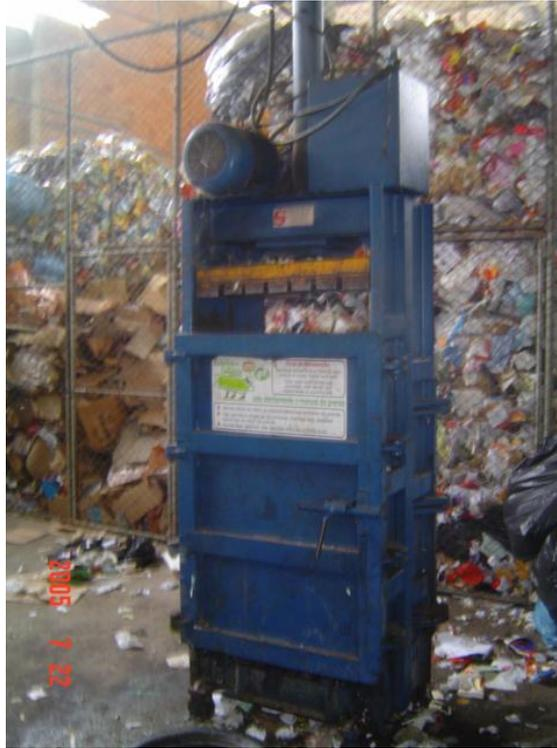
**Figura 11:** Prensa vertical para compactação de resíduos.
