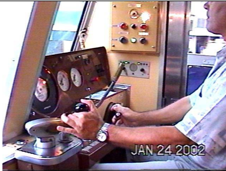
Figura 23: Acionamento dos manípulos de frenagem (à direita) e de velocidade (à esquerda).
