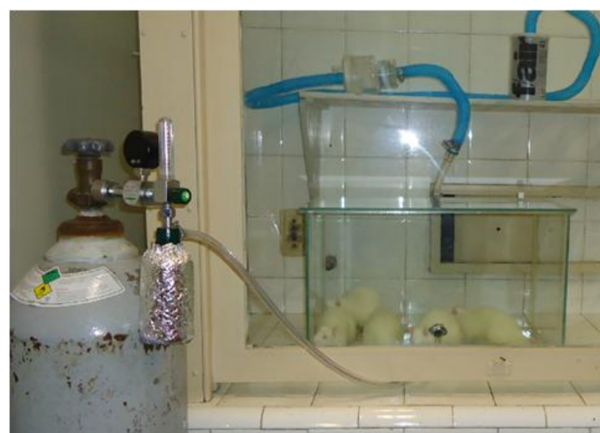
Figura 1. Sistema de exposição inalatória: câmara de vidro hermeticamente fechada, contendo uma entrada (passagem de BaP + ar) e uma saída adaptada a um filtro especial para coleta de BaP.
