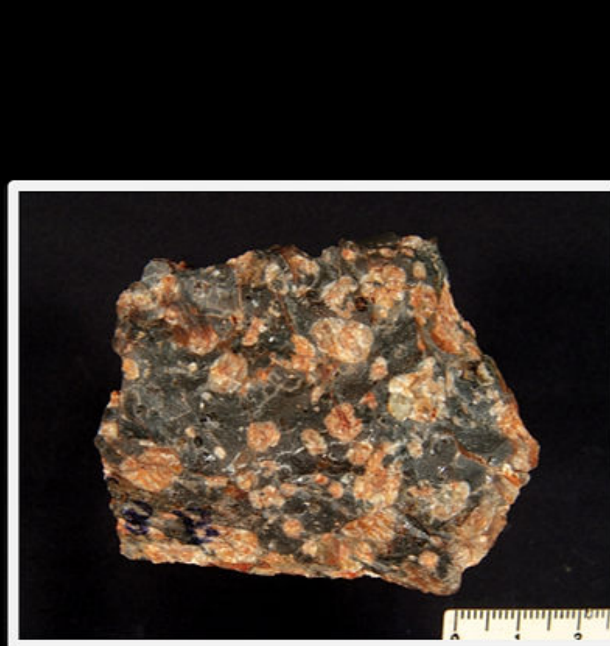
Figura 10: Amostra representativa dos diques de riolitos porfíricos com fenocristais euédricos, envoltos por matriz afanítica.
