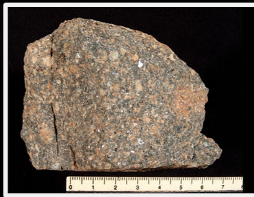
Figura 5: Amostra representativa da fácies equigranular fina a seriada: corpo riolítico principal.
