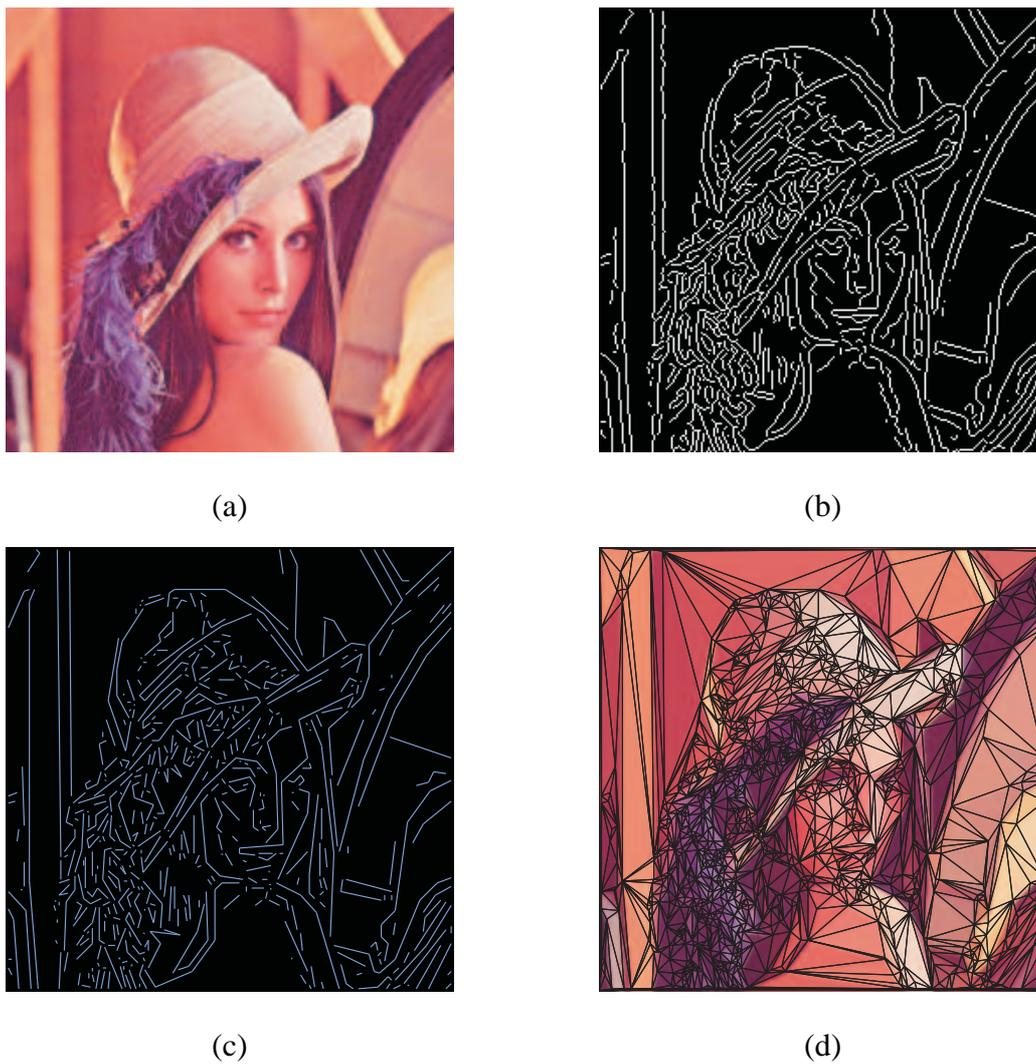
Figura 5.4: Processo de criação de uma Triangulação de Delaunay com Restrições (a) imagem original; (b) mapa de bordas; (c) aproximação por segmentos de retas; (d) Triangulação de Delaunay com Restrições correspondente.
