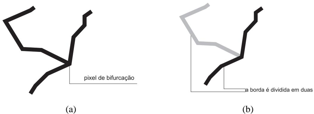
Figura 5.2: Exemplo de uma borda conexa com uma bifurcação (a) o pixel com mais de dois vizinhos é localizado; (b) a borda é quebrada em duas.
