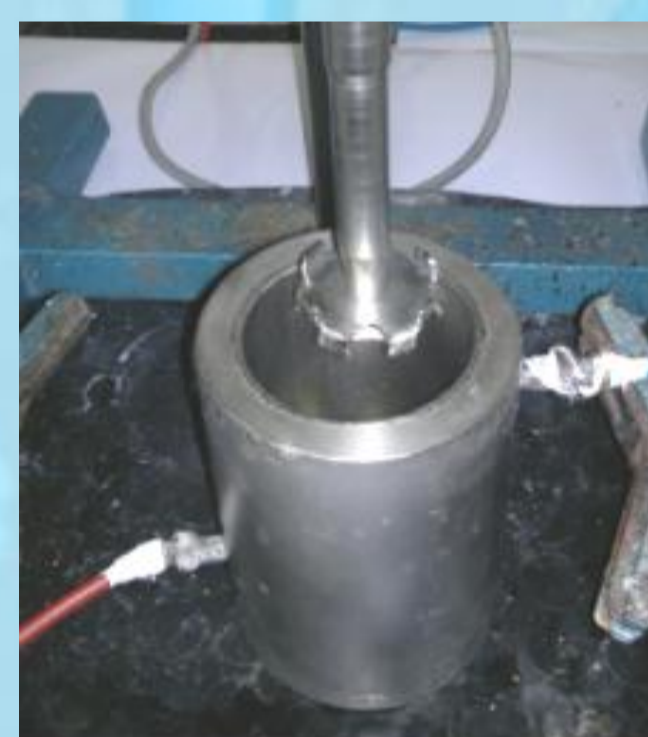
Figura 3. Reator encamisado – Disco tipo Cowles.
