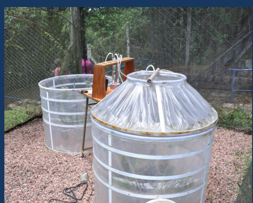
Figura 1: Sistema de exposição ao ozônio. 1. Ozonizador, 2. Entrada de ar, 3. Câmara de homogeneização, 4. Ventilador homogenizador de ar, 5. Câmara de topo aberto, 6. Tubulação para amostra de ar para medição, 7. Amostrador atmosférico para O 3 .
