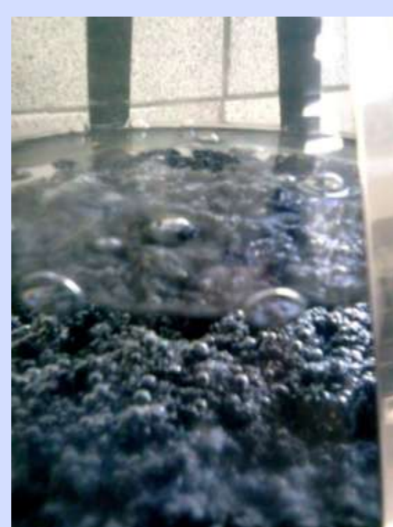
Fig. 2: Retirada de ar da amostra de concreto asfáltico.
