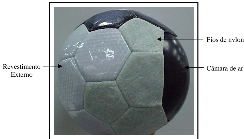
Figura 8 – Composição básica das bolas
