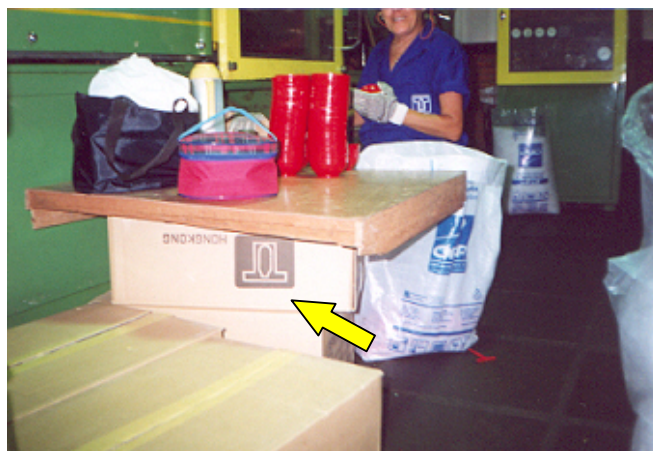
Figura 13 Superfície de trabalho (lâmina de compensado) desnivelada e disposta sobre duas caixas de papelão podendo gerar acidentes
