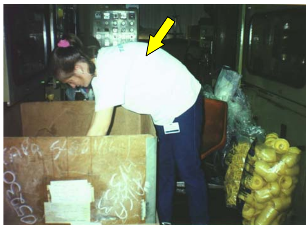
Figura 9 Flexão frontal do tronco devido ao baixo nível do contenedor de peças prontas
