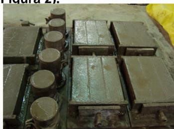
Figura 2 – Corpos-de-prova de argamassa depois da moldagem.
