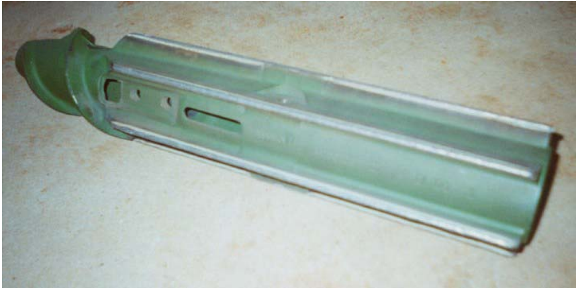
Figura 3.3 – Peça com a Solda de Revestimento Aplicada nas Aletas
