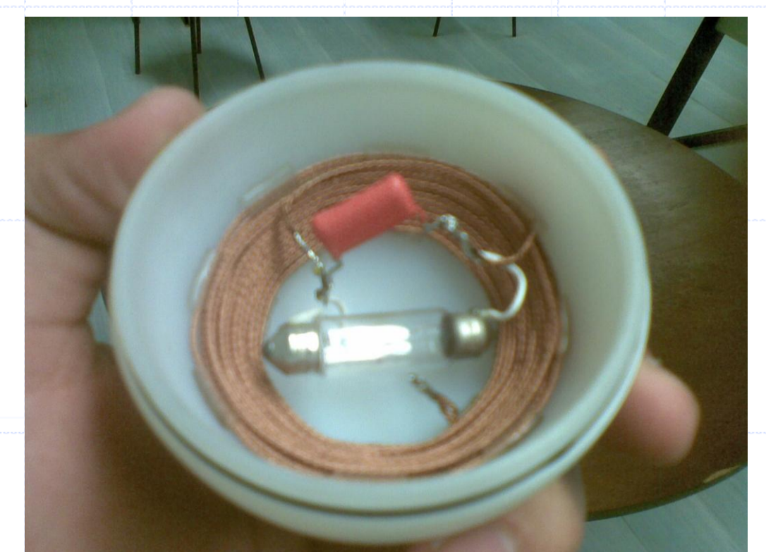
Figura 7 – Interior da esfera com o circuito ressonante e uma lâmpada para demonstração da transferência de energia
