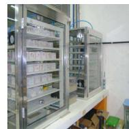
Figura 04. Câmaras de carbonatação
