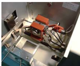
Figura 2: Calibração com Material de Referência Certificado (SRM 1634c).
