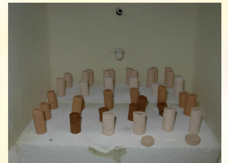
Figura 5 - tubos cerâmicos no forno, logo após a sinterização.
