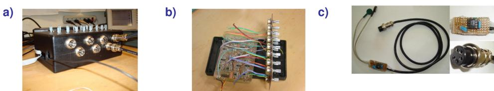
Figura 3: a) eletromiógrafo SMT b) detalhe placa SMT do eletromiógrafo e c) cabos do eletromiógrafo.
