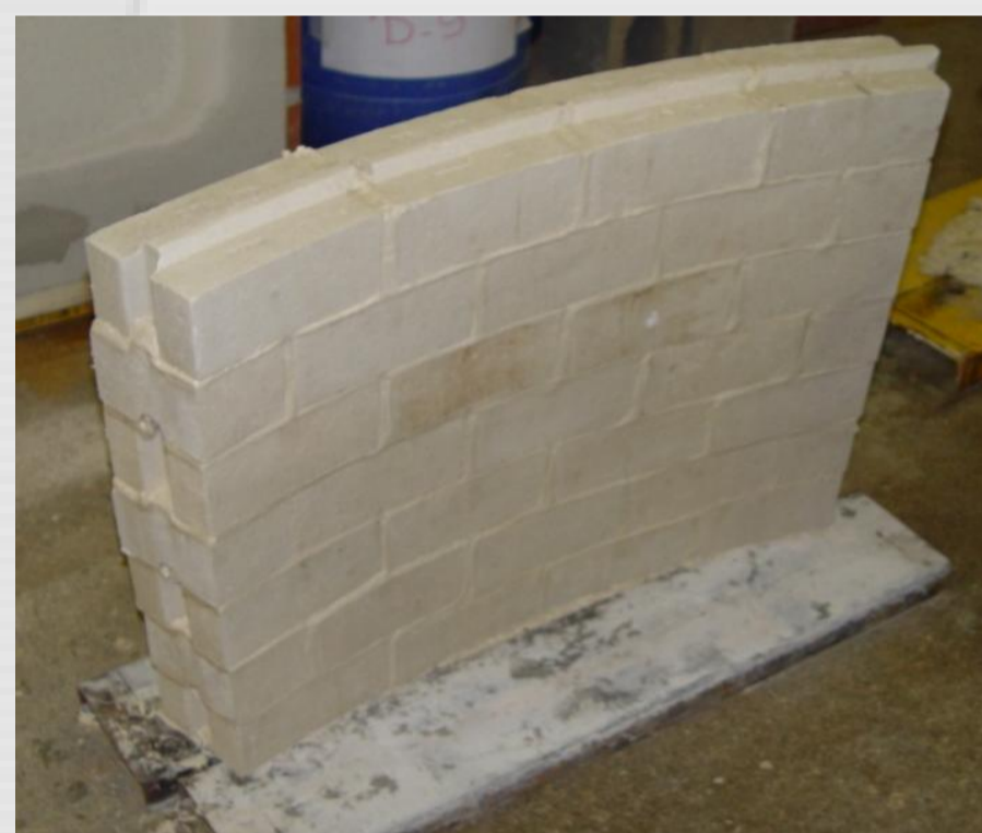
Figura 1 – Ensaio de comportamento térmico: Mini-parede construída.
