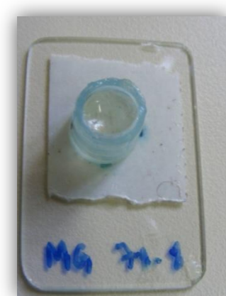
Figura 5: Montagem dos grãos em resina epóxi com zircões dispostos em 10 linhas e 5 colunas. Diâmetro do recipiente: 0,8 cm.
