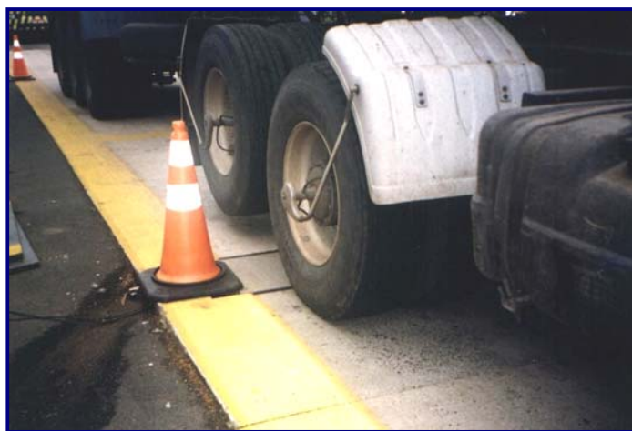
Figura 10 – Um exemplo de balança com tecnologia blending plate em funcionamento
