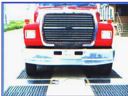
Figura 8 – Sensores apoiados em esteiras sobre a superfície nivelada da rodovia
