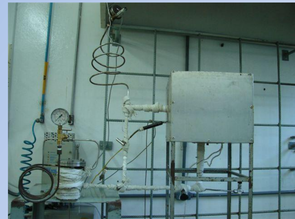
Figura 1: Sistema de pré-tratamento hidrotérmico
